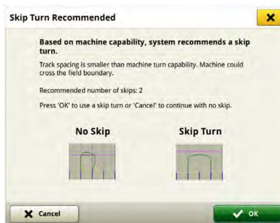
El sistema realizará esta recomendación de omisión de giro cuando el espacio entre pasadas de la máquina sea menor que el diámetro de giro mínimo de la máquina, o cuando un giro planificado salga del límite del campo porque el cabecero no es lo suficientemente grande como para realizar el giro con éxito usando los ajustes actuales.
